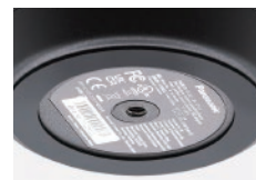
三脚固定ネジ穴 ねじ:1/4-20UNC
