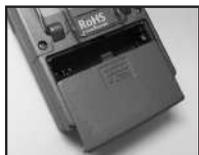
1. 写真の OPEN の位置を押し電池カバー(12)を下方向に外します。単三形ニッケル水素充電式電池(1900mAh 推奨)または乾電池を 2 本入れます。
